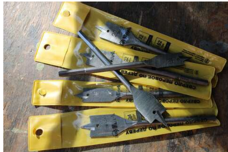
набор перовых сверл разного калибра для работы с деревом
